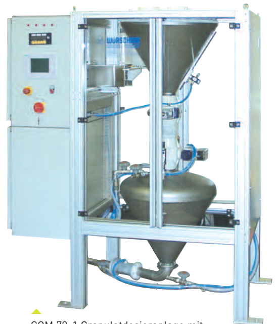
▲ COM 70-1 Granulatdosieranlage mit separatem Sendegeäß als Zwischenpuffer
