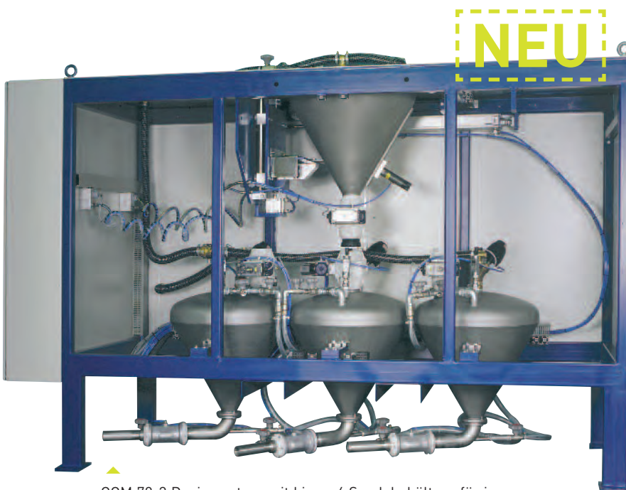
▲ COM 70-3 Dosiersystem mit bis zu 6 Sendebehältern für je einen Mischer oder um bis zu 6 Farbchargen zu verwiegen und für sofortigen Abruf zu puffern
