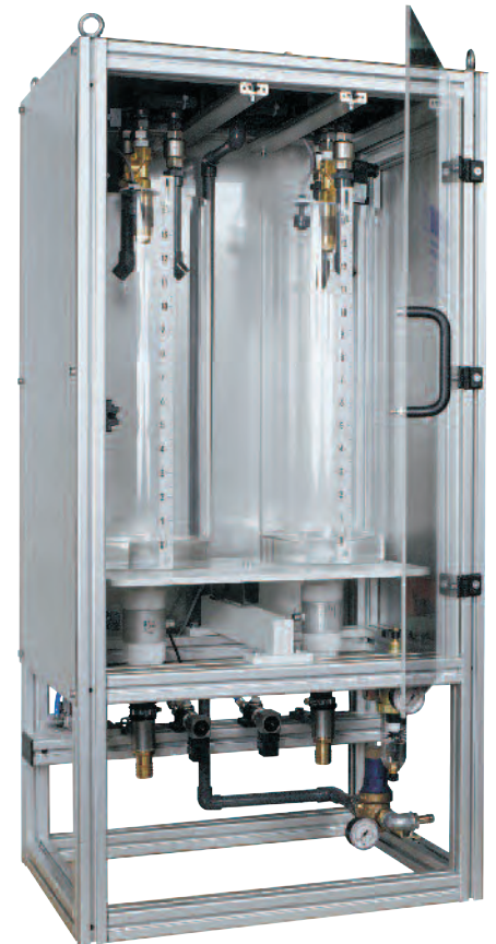
Waage AC 15/15 mit 2 Acrylglaszylindern je 15 Liter
